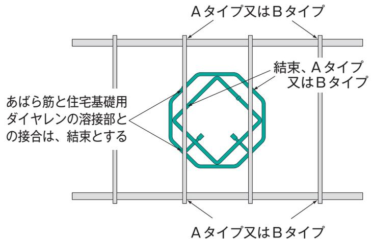
・日本建築センター評定区分：組立鉄筋Aタイプ、組立鉄筋Bタイプ、段取り筋溶接（仮組み溶接鉄筋工法）
