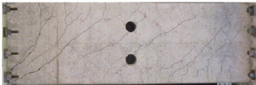
VH-30 (開口補強金物: KSS785-K・S10)
